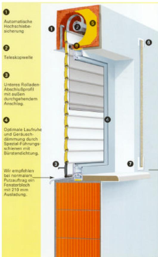
Der hier untersuchte Rolladenkasten ist raumseitig geschlossen. Arbeiten im Kasten sind durch eine äußere Revisionsöffnung durchzuführen. Bei dieser Konstruktion sind die Problempunkte
